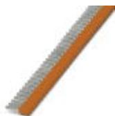
Кабельные наконечники в лентах, 0,5 мм<sup>2</sup>, длина наконечника 8 мм, с пластиковыми втулками, согласно DIN 46228-4, специальный цвет: оранжевый, с функциональным концом для надежной и удобной обработки при помощи Crimphandy, 20 полос по 50 наконечников.
