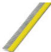
Кабельные наконечники в лентах, 1,0 мм<sup>2</sup>, длина наконечника 8 мм, с пластиковыми втулками, согласно DIN 46228-4, спец. цвет желтый, с функциональным концом для надежной и удобной обработки при помощи Crimphandy, 20 полос по 50 наконечников.
