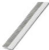
Кабельные наконечники в лентах, 0,5 мм<sup>2</sup>, длина наконечника 8 мм, с пластиковыми втулками, согласно DIN 46228-4, цвет белый, с функциональным концом для надежной и удобной обработки при помощи Crimphandy, 20 полос по 50 наконечников.
