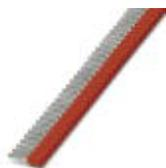
Кабельные наконечники в лентах, 1,5 мм<sup>2</sup>, длина наконечника 8 мм, с пластиковыми втулками, согласно DIN 46228-4, спец. цвет красный, с функциональным концом для надежной и удобной обработки при помощи Crimphandy, 20 полос по 50 наконечников.
